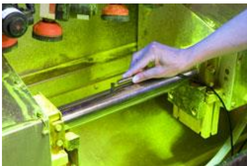
Przykład: Pomiar natężenia pola podczas magnesowania za pomocą przepływu strumienia magnetycznego
