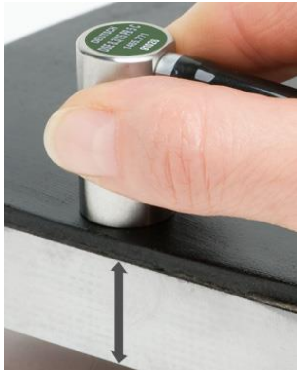
Przykładowy pomiar płyty pokrytej powłoką gumową
